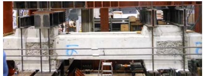
写真1 柱の最終破壊状況
