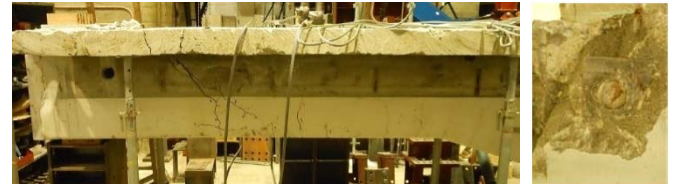
(a) 最終破壊状況 (b) 定着部溶接破断 写真2 梁の最終破壊状況
